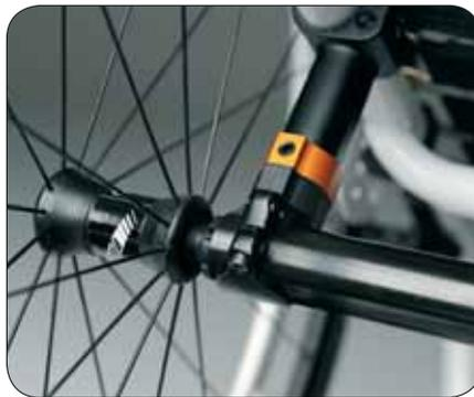
Plaque d'essieu fixe avec réglage de la hauteur d'assise.
