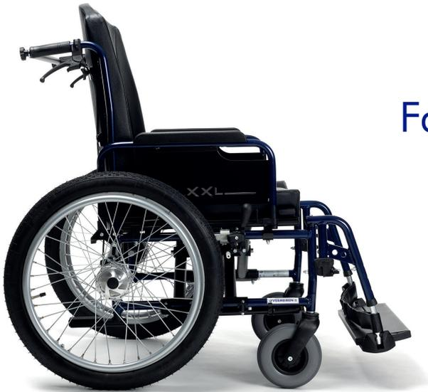
L'Eclips XXL est fabriqué en standard avec une assise et un dossier fixes et amovibles. Le double croisillon, associé à des essieux arrière renforcés et à des roues de 23" spécialement renforcées, permet de supporter une charge maximale de 250 kg.
