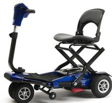
Scooter de voyage. Pratique pour les courtes distances, pliable rapidement et facile à emporter comme bagage pour le train ou l'avion (y compris les batteries). Se manœuvre facilement. Convient également à une utilisation dans des pièces de petite taille.
